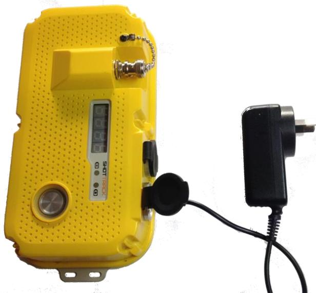
La recarga se realiza conectando un enchufe estándar de 12-voltios en el conector posterior del lado derecho.
