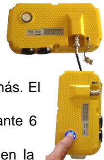
*Si después de leer los datos obtenidos, la unidad detecta que el cable ha vuelto a su longitud original, entonces la unidad se RE-CONFIGURARA por sí sola asumiendo que una condición transitoria de disparo ha activado falsamente la unidad (por ejemplo, un camión que pasa sobre el cable)*
